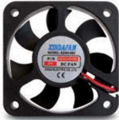
Ventilateur miniature 5 V DC. Dim. 50 x 50 x 10 mm, 0,22A, 1,10 Watt, 5200 t/mn, débit 12,5 m<sup>3</sup>/mm, bruit 32,9 dB(A), poids 20 g
