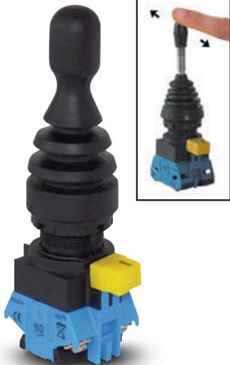
Le levier reste en position et ne revient pas automatiquement au centre en le relâchant. Courant de contact max. 440 V AC et DC, 10 A, fixation par écrou central prof. d'encastrement env. 70 mm, long. levier 75 mm, diam. d'encastrement 22 mm.
