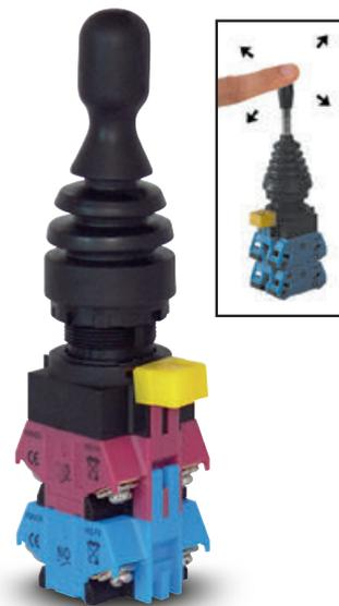
Retour automatique du levier en position centrale. Courant de contact max. 440 V AC et DC, 10 A, fixation par écrou central. Prof. d'encastrement env. 70 mm, long. levier 75 mm, diam. d'encastrement 22 mm.
