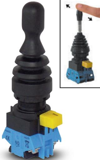
Retour automatique du levier en position centrale en le relâchant. Courant de contact max. 440 V AC et DC, 10 A, fixation par écrou central prof. d'encastrement env. 70 mm, long. levier 75 mm, diam. d'encastrement 22 mm. CE
