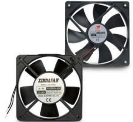
Ventilateur 220 V AC/50 Hz, 0,14 A. Dimensions 120 x 120 x 38 mm, puissance 31 W, vitesse 2600 t/min, débit 128 m<sup>3</sup>/h.
